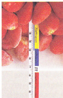
B4 Ethanol als Thermometerfüllung
