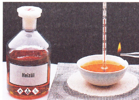
B8 Bestimmung der Flammpunkttemperatur: Bei langsamem Erwärmen wird die Temperatur der Flüssigkeit abgelesen, bei der sich die Dämpfe über ihr erstmals entflammen lassen
