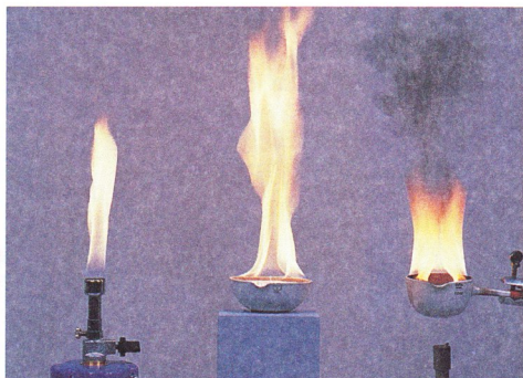
B7 Flammenvergleich (von links: Butan, Benzin, Paraffinöl)
